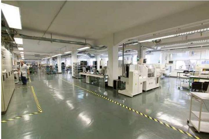
Der Fußboden ist auf der ganzen Fläche ableitfähig und somit gut geeignet für Elektronikfertigungen aller Art und natürlich auch für Fertigungen oder Werkstätten, die keine Ableitfähigkeit benötigen
